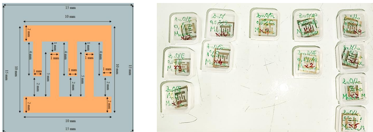
Fig. 6.1 .Diagrama măștii mecanice folosite pentru a realiza electrozii metalici
