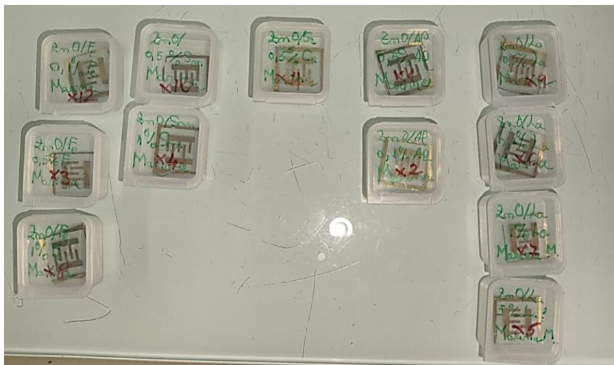
Figura 4.11 Câteva exemple de filme subțiri de ZnO pur și ZnO dopat pe care s-au depus electrozi interdigitați de Au.
