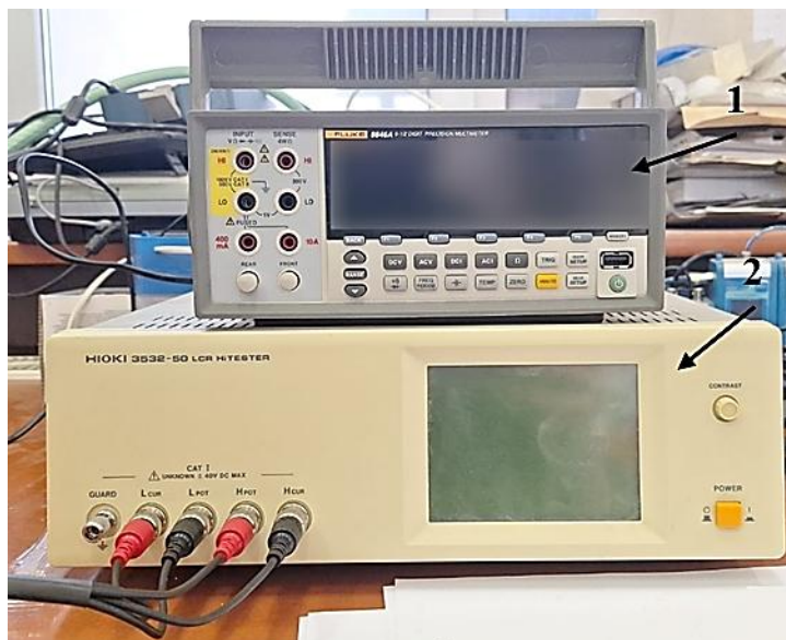
Fig. 6.2 Montajul experimental utilizat pentru măsurarea rezistenței și a impedenței: (1) Multimetru FLUKE 8846A, (2) Hioki 3532-50 LCR Hi-Tester
